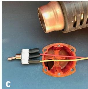
Chauffez la gaine au sèche-cheveux ou au décapeur thermique jusqu'à ce qu'elle se colle parfaitement au connecteur.
