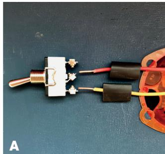
Enfilez une gaine thermo-rétractable (1) sur chaque fil dénudé de 8mm.
